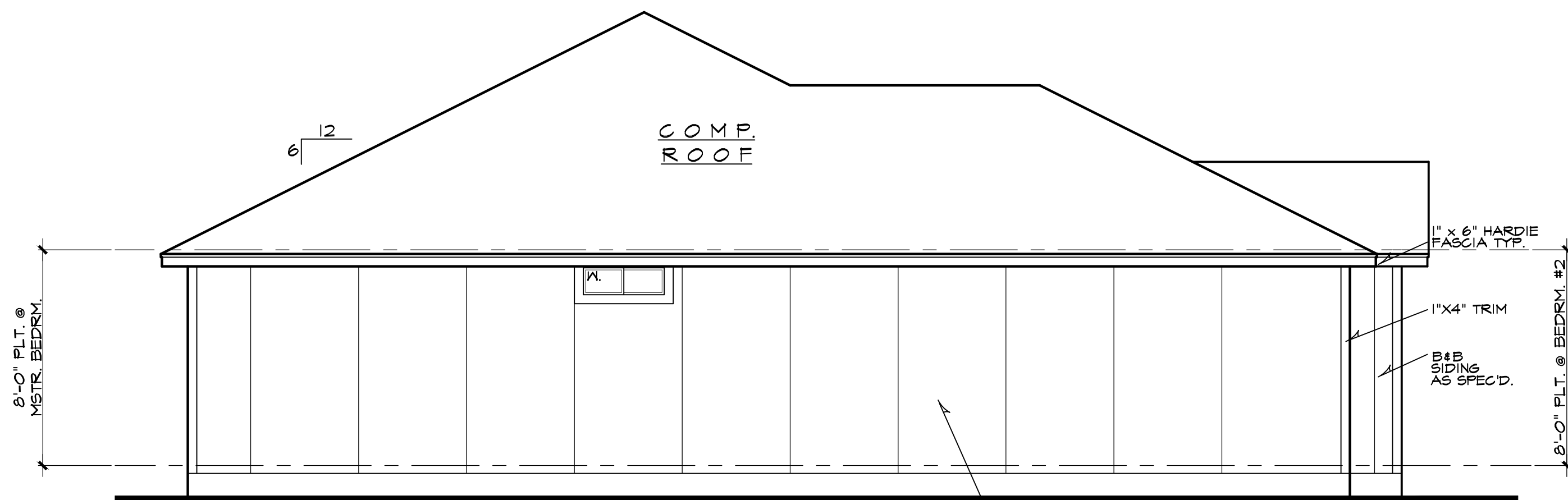
LEFT ELEVATION SCALE: 1/4" = 1'-0"
